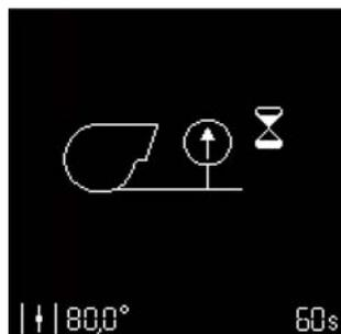
Проверка реле давления воздуха
