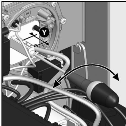
**Регулировка подачи воздуха в головку горелки**, помимо расхода воздуха, влияет также на зону смешивания и давление воздуха в сопле горелки. Вращение винта **A**
