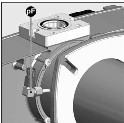
**!** Нельзя перекрывать датчик давления камеры сгорания **pF**.
