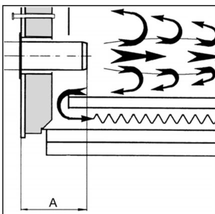
Для котлов с глухой камерой сгорания при выборе минимальной глубины **A** сопла горелки необходимо руководствоваться указаниями производителя котла.
